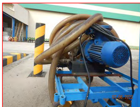
ปั๊มของเหลว (Diaphragm Pump) สำหรับสูบน้ำสารเคมีที่ รั่วไหลลงถัง
