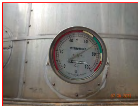
ภาพที่ 2.2-69 อุปกรณ์วัดอุณหภูมิ (Temperature Indicator) ในพื้นที่กระบวนการผลิต
